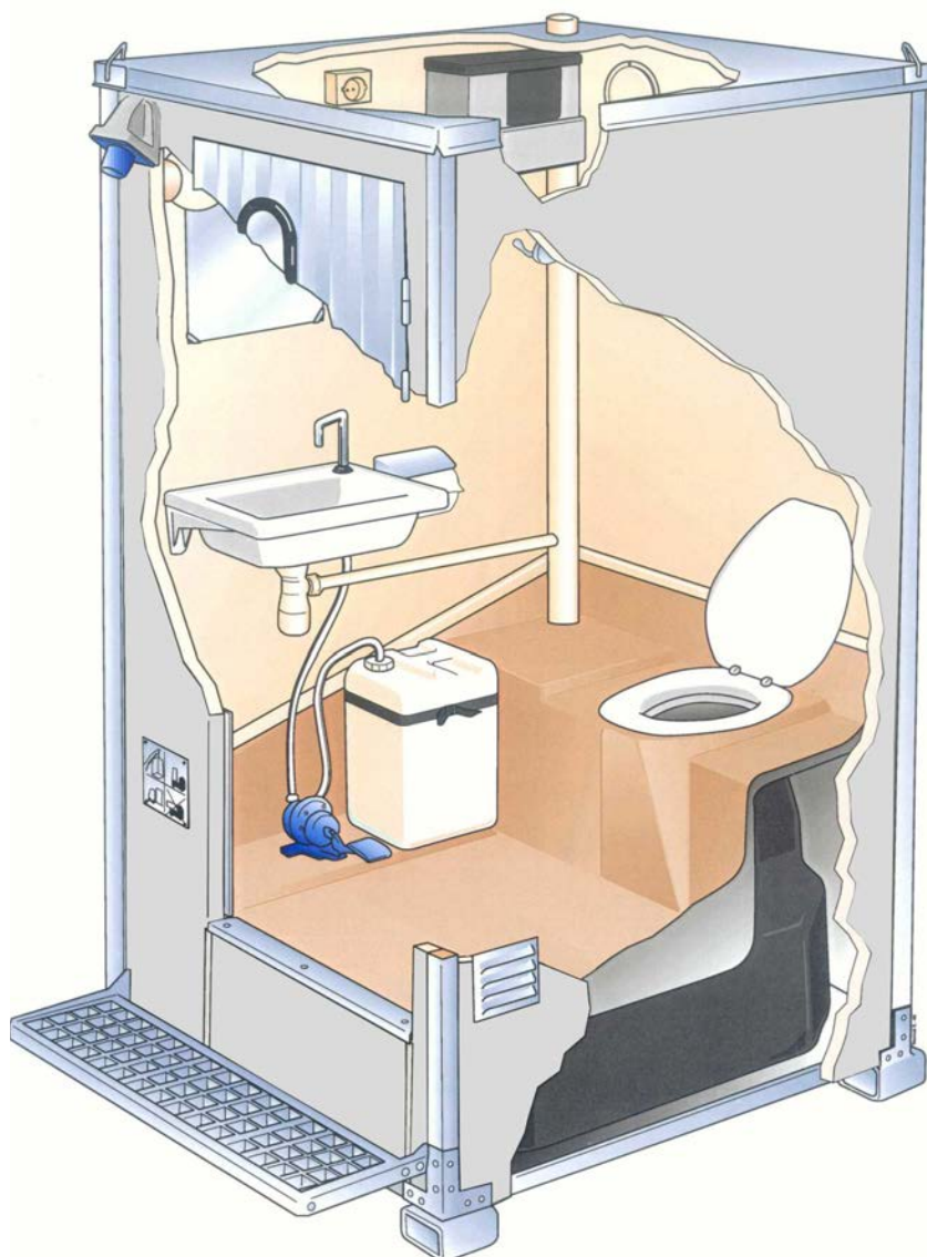
Genomskärning av en Toalett-kabin med latrintank.
